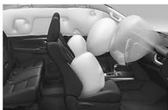
에어백은 대표적으로 운전석 핸들 속, 조수석, 측면에 위치하고 그 외에도 커튼형 에어백, 무릎 에어백 등이 내부에 위치한다. 최근에는 에어백은 차량 밖에도 위치하여 도보를 걷던 행인과 부딪힐 경우 행인이 다치는 일을 줄여주기 위한 에어백, 차량 간의 충돌 시 피해를 최소화하는 에어백도 있다.
