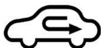
내기 순환은 외부 공기의 유입 없이 차량의 실내 공기 질을 개선시켜 주는 것을 말한다. 즉, 차량 내부 에어컨 필터를 통해 공기를 정화 시켜주는 역할을 한다. 내기 순환은 차량 내부에 있는 공기로만 순환을 해 외부의 먼지나 가스, 악취 등을 차단할 수 있다는 장점이 있다. 하지만, 내기 순환 모드로 장시간 주행 시 차량 내부에는 새로운 공기가 유입되지 않게 되어 곧 차량 내부에 이산화탄소가 축적되고 운전자에게 즐음과 두통을 야기할 수 있다. 이런 이유 때문에 내기순환을 하더라도 주기적
