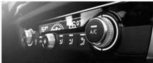
차량 내·외부의 공기는 자동차 공조 장치를 통해 유입된다. 자동차 공조 장치(HVAC)는 Heating, Ventilation, Air Conditioning의 약자로 단순히 에어컨과 히터의 기능을 하는 것만이 아닌 외부 공기가 차 내로 유입되는 통로이기도 하다. 따라서 공조 장치는 차 안의 온도 조절 외에도 공기의 흐름, 습도, 청정도 등을 유지 시켜주는 중요한 역할을 한다. 특히 공조 장치는 외기 순환과 내기 순환이라는 기능을 가지고 있다. 이 둘은 역할과 사용 방법이 구분되어 있다.
