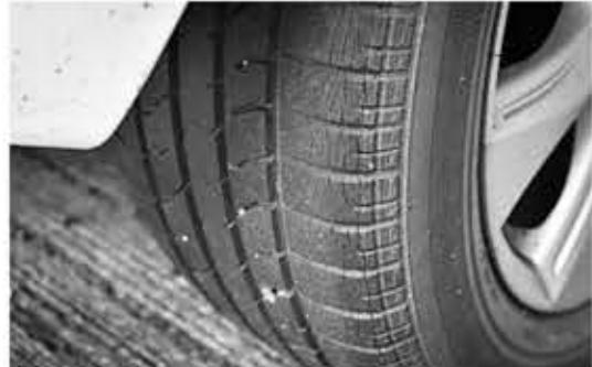
타이어의 트레드는 도로 면과 직접 닿는 부분으로 타이어의 성능을 좌우하고 배수력과 제동력을 발휘하는 부분이다. 두껍고 내성이 강한 부분이긴 하지만 주기적인 공기압 관리와 점검이 부족하면 크랙이 발생할 수 있다. 또, 적재량이 많은 차량의 하중 초과도 트레드 크랙 발생 원인이 되며 차량을 자주 사용하지 않는다 해도 5년 이상 된 타이어는 노화현상이 발생합니다. 이러한 크랙은 당장 안전에 문제가 발생하지는 않지만 크랙이 커지고 많아지게 되면 타이어 파열로 이어질 수 있으니 빠른 시일 내 교체하는 것이 좋다.
