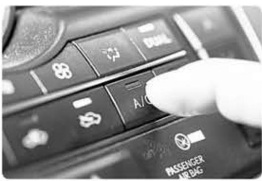
히터를 작동할 때 연료가 소모되는 상황도 있습니다. 첫번째는 히터와 A/C버튼을 함께 사용하는 경우이다. A/C버튼은 엔진의 힘을 이용해 컴프레서를 작동시켜 차 내부 공기를 제습하는 역할을 한다. 따라서 꼭 에어컨을 틀 때만이 아닌 히터를 틀 때에도 함께 사용할 수 있다. 만약 히터와 A/C버튼을 함께 작동할 경우, 컴프레서를 작동시키기 위한 엔진의 추가적인 힘이 필요하므로 히터만 틀 때보다 연료가 추가적으로 소모된다.
