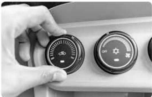
에어컨은 연비에 영향을 주지만 히터는 연비에 영향을 주지 않는다. 에어컨과 달리 히터의 따뜻한 바람은 엔진 열을 이용한다. 내연기관 자동차들은 연료를 폭발시켜 엔진을 작동하게 되고 이 과정에서 생기는 열에 송풍을 데려 히터, 즉 따뜻한 바람을 내보내는 것이다. 따라서 히터를 끈다고 추가적인 연료가 소모되는 것이 아니기 때문에 히터와 연비 하락과는 직접적인 연관이 없다.
