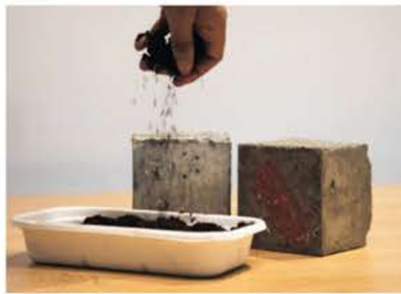
▲ 호주 RMIT대 연구진은 구운 커피 찌꺼기를 배합해 콘크리트 강도를 크게 끌어올릴 수 있는 신기술을 개발했다. 사진=quarymagazine
