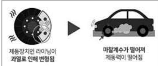
긴 내리막길처럼 속도가 빠른 곳에서는 브레이크의 진도가 높아지게 마련이다. 그런데 브레이크를 자주 밟아 생기는 마찰열은 제동장치 중 하나인 라이닝(브레이크 드럼과 접촉하여 회전을 멈추는 마찰재)을 변형시킨다. 이때 마찰계수가 급격히 떨어져 브레이크가 밀리거나 작동하지 않게 되는데, 이를 페이드 현상이라고 한다. 드럼(브레이크 패드를 압착하여 제동하는 장치)식 브레이크에서 더 자주 발생한다. 페이드 현상의 심상황에서 별도 조치 없이 브레이크를 사용하게 되면 베이퍼록 현상 발생의 원인이 된다.
