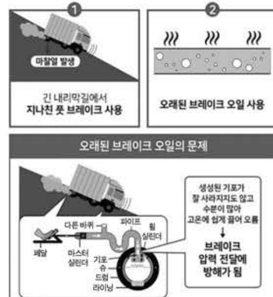
페이드 현상이나 베이퍼록 현상은 긴 내리막길을 주행할 때 풋브레이크를 지나치게 사용할 시 발생한다. 더불어 오래된 브레이크 오일 사용 시 발생하기도하는데, 이는 수분 함량이 높은 브레이크 오일이 끓어올라 생긴 기포가 브레이크 압력 전달에 방해하기 때문이다.
