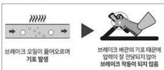
베이퍼록 현상은 브레이크를 사용할 때 자동차 바퀴에 생기는 마찰열로 인해 브레이크 오일이 끓어오르며 생기는 기포로 제동력이 떨어지는 현상을 말한다. 특히 여름철엔 달궈진 아스팔트 복사열로 자동차 바퀴에 증기와 증기면서 브레이크가 더 잘 잡긴
