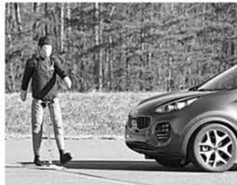
▲ 한 자동차회사의 AEB 테스트 장면. 사진=motortrend.com
