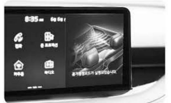
최근 출시된 자동차 가운데는 차량 내 장착된 미세먼지 센서를 이용해 실내 미세먼지 농도를 감지하고 자동으로 공기 청정 모드를 작동시켜 실내 공기를 쾌적하게 유지하는 '능동형 공기 청정 시스템'이 탑재된 것도 있다. 공기 청정 모드가 작동하면 내기 순환 변경 / 에어컨 작동 / 풍량 증대를 통해 빠르게 실내 공기를 쾌적하게 바꾸어 준다. 물론 대기질과 상관없이 실내 공기가 탁하다고 느끼면 공기 청정 모드 버튼을 눌러 수동으로 작동시키는 것도 가능하다.
