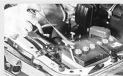
다른 계절에 비해 겨울철에 배터리가 방전되는 경우가 많다. 이는 다른 계절에 비해 전기장치 사용이 늘어나기 때문인데, 이를 예방하기 위해서는 자동차 시동을 바로 끄기보다, 히터를 먼저 끈 후 5분 정도 후에 시동을 끄는 것이 좋다. 또한 배터리는 온도에 민감하기 때문에 겨울철에는 실외보다는 실내에 주차하고, 배터리 주변을 웃이나 담요 등으로 감싸 추운 날씨에 배터리액이 얼지 않도록 해주면 좋다.
