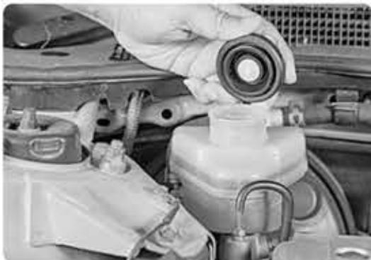
보닛을 열면 브레이크 액이 저장된 탱크가 보이는 데, 주기적으로 브레이크 액 탱크의 눈금이 'MIN'과 'MAX' 사이에 있는지 살피고 점검해야 한다. 정상적인 조건에서 브레이크 액이 급격히 소모되는 경우는 없다. 하지만 브레이크 패드가 마모되면서
