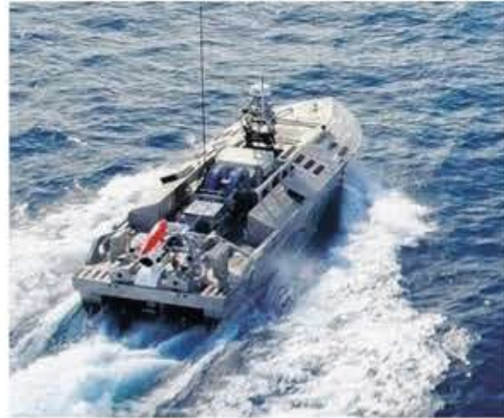
▲ 미국 텍스트론사의 공통 무인수상정(CUSV) 기반의 기뢰 탐색 제거 시스템인 무인감응 기뢰 소해시스템(UISS, Unmanned Influence Sweep System) 사진=미 해군
