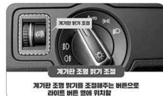
주변 상황에 따라서 자동차 계기판의 밝기를 조절하면 안전 운전에 도움이 된다. 특히, 야간 운전을 할 때는 마주오는 차의 전조등, 앞차의 브레이크등 때문에 눈의 피로도가 높아지는데 거기에 더하여 계기판의 조명이 너무 밝으면 전방 시야가 흐려질 수 있다. 따라서 야간 운행을 할 때에는 적당한 수준으로 계기판의 밝기를 조절 후 운전하면 안전운전에 도움이 된다.
