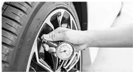
타이어 공기압 역시 연비에 영향을 미친다. 타이어의 공기압이 낮아지면 지면과 타이어 사이의 접촉 면적이 넓어져 마찰이 커지고 결과적으로 연비에 악영향을 미친다. 폭이 넓은 타이어를 사용하는 스포츠카 또는 스포츠 세단의 연비가 좋지 못한 것은 타이어 탓도 크다. 그만큼 상대적으로 많은 저항을 감당하면서 달려야 하기 때문이다.
