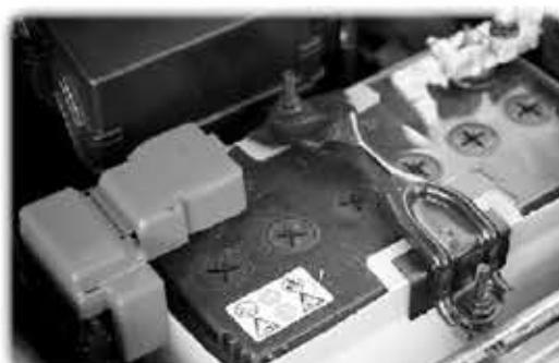
배터리는 계기판에 뜨는 배터리 경고등과 엔진룸에 있는 배터리의 인디케이터의 색상을 통해 배터리의 잔량을 확인할 수 있다(인디케이터가 없는 배터리도 있다).
