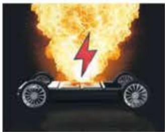
그 이유는 리튬이온전지의 특성인 열 폭주 때문이다. 설계 오류, 제조 결함, 과충전 등 다양한 스트레스로 인해 순식간에 내부 온도가 섭씨 1천도 가량 치솟는 현상이다. 보통 양극과 음극을 나누는 분리막이 손상돼 일어난다. 문제는 이런 리튬이온전지 셀이 수십 개씩 붙어있는 구조다. 하나가 폭주하면 근처 셀까지 영향을 받기에 전기차 화재는 보통 전소되기 전까진 끄기 어렵다.
