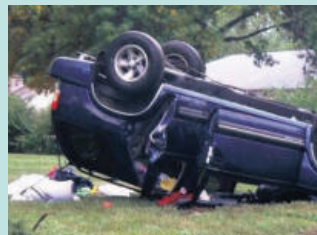
지붕파손 / 차량전복 Roof Crush / Roll Overs
