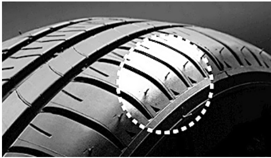
▲ 타이어 스푸는 제조 공정 중 자연스럽게 발생하며 운행 중 마모되어 사라진다.
