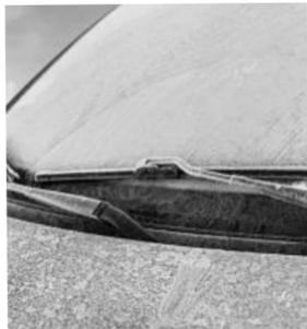
김 서림과 성에 모두 자동차 내부와 외부의 온도 차이에서 오는 현상이라는 점에서 비슷하지만 성에는 주로 겨울철에 자동차 유리 바깥쪽 수증기가 승화하면서 얼어붙어 만들어지는 서리를 말한다.
