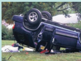
지붕파손 / 차량전복 Roof Crush / Roll Overs
