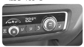
자동차 히터를 내기 순환 모드로 장시간 동안 작동해 높은 실내 온도로 차량을 주행하면 차량 내부에 산소 부족이 발행해 운전 중 집중력 저하나 졸음 운전을 야기할 수 있다. 또한 실내 공기가 건조해져 호흡기 질환이나 피부에 악영향을 끼칠 수도 있기 때문에 히터는 적절한 온도와 바람세기를 조절해 사용해야 한다. 자량 내부 온도는 보통 섭씨 21-23도로 설정하는 것이 좋다.
