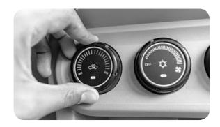
자동차 히터는 연료 분사와 폭발 작용으로 뜨거워진 엔진의 열을 차량 냉각수로 식히면서 얻어지는 열을 이 용한 난방 방식이다. 그러므로 시동을 걸자마자 히터를 켜면 엔진이 충분히 가열되지 않은 뜨거운 바람이 나오
