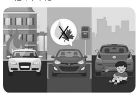
머플러를 통해 자동차 내부의 문제를 체크하는 것 도 중요하지만, 머플러로 인한 외부 사고에도 주의가 필요하다. 머플러에서는 뜨거운 배기가스가 배출되 므로 항상 화재 및 화상 사고를 조심해야 한다. 주 · 정차 시 인화 물질(종이, 오일 등)이 없는지 확인해야 하며, 낙엽이나 마른 풀이 머플러에 들어가지 않도록 조심해야 한다.이 외에도 벽에 가까운 상태에서 공회 전을 할 경우 배기가스 열로 인해 화재가 발생할 수 있기 때문에 머플러를 벽에 바짝 붙지 않게 주·정차 하는 것이 좋으며, 점검 시 고온의 머플러에 화상을 입지 않도록 주의해야 한다.
