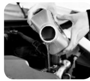
자동차 엔진의 기능이 제대로 작동하도록 돕는 엔진오일 역시 기본적인 자동차 점검 리스트에서 빠질 수 없다. 엔진오일은 엔진 부품이 마모되지 않도록 돕고 냉각 작용 및 실린더와
