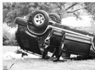
지붕파손 / 차량전복 Roof Crush / Roll Overs
