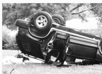
지붕파손 / 차량전복 Roof Crush / Roll Overs
