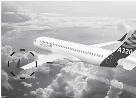
비행기의 날개의 끝부분을 구부리면 공기의 움직임이 바뀐다. 공기의 움직임이 바뀌면서 비행기의 움직임을 방해하는 공기 저항의 일종인 '와류'가 적게 만들어지게 된다. 부드럽게 구부러진 부분이 공기의 흐름을 바꿔 회오리가 만들어지는 것을 방해하는 원리다. 와류가 클수록 비행기는 앞으로 나아가기 위해 더 많은 연료를 써야 하는데, 와류가 적어지면 그 보다 적은 연료를 쓸 수 있다. 에어버스는 이 날개로 기존의 항공기보다 연료 사용량을 4% 줄이고 연료 효율은 15% 높일 수 있었다.
