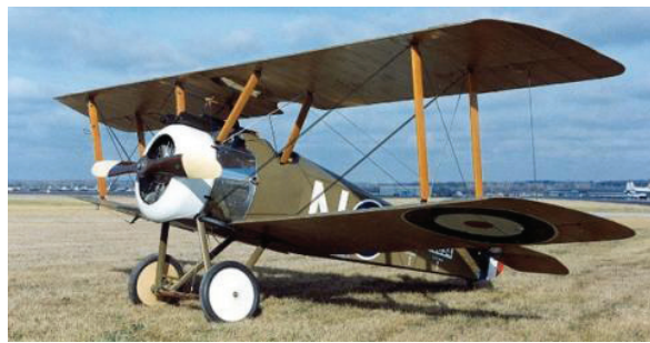
▲ 초창기 비행기 날개에 적용되었던 트러스 구조는 무게를 지지하는 용도로 사용되었다.
