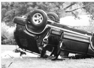
지붕파손 / 차량전복 Roof Crush / Roll Overs
