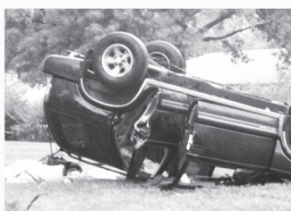
지붕파손 / 차량전복 Roof Crush / Roll Overs
